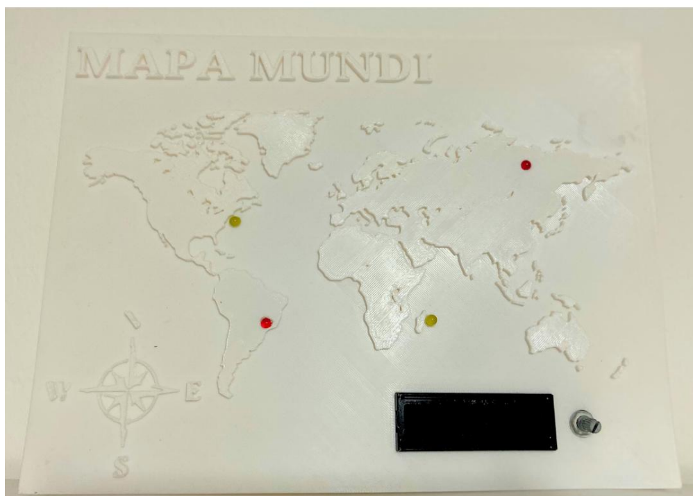
Figura 1: Mapa-múndi interativo impresso em ABS, controlado por ESP32, com LEDs indicadores e display LCD para visualização dinâmica de localizações..
