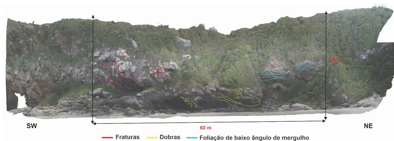
Figura 1: Ortofoto de vista frontal 2D mostrando dobras, fraturas e foliação de baixo ângulo de mergulho
